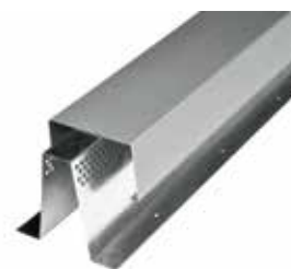
Faîtage ventilé (double pente section 224 cm 2 /m, monopente et monopente contre mur section 112 cm 2 /m)
