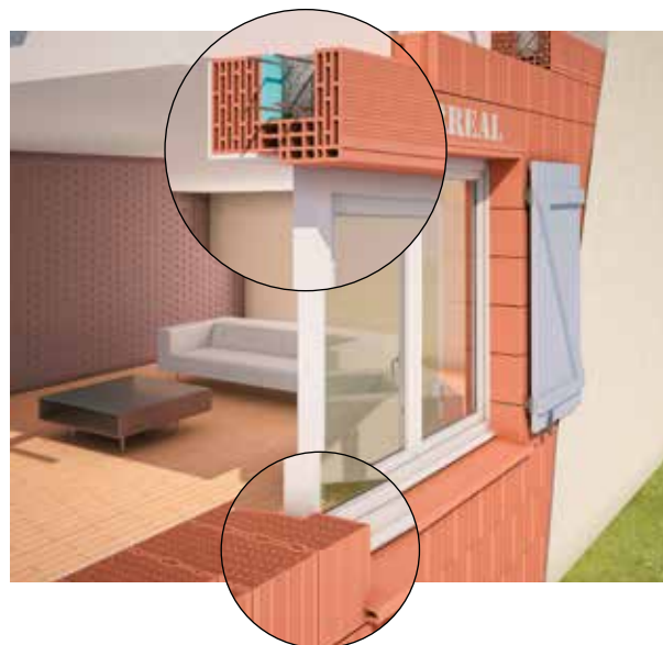
Menuiserie posée en tunnel
