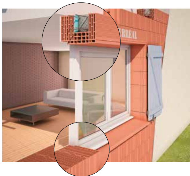
Menuiserie posée en feuillure
