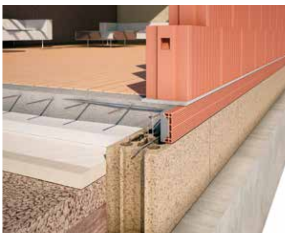
Plancher bas sur terre-plein avec dalle pleine
