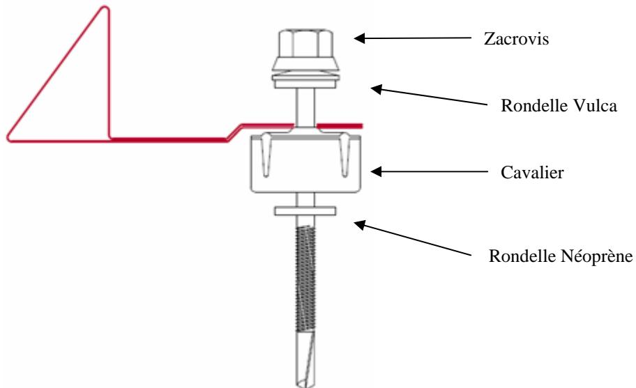
Attention : la charge d'utilisation d'un STOPCO ne doit jamais excéder 100 daN afin de ne pas fragiliser la fixation
