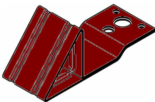
Description : Crochet garde neige pour bacs acier nervurés, T.O.G ou FIBRES- CIMENTS G.O
