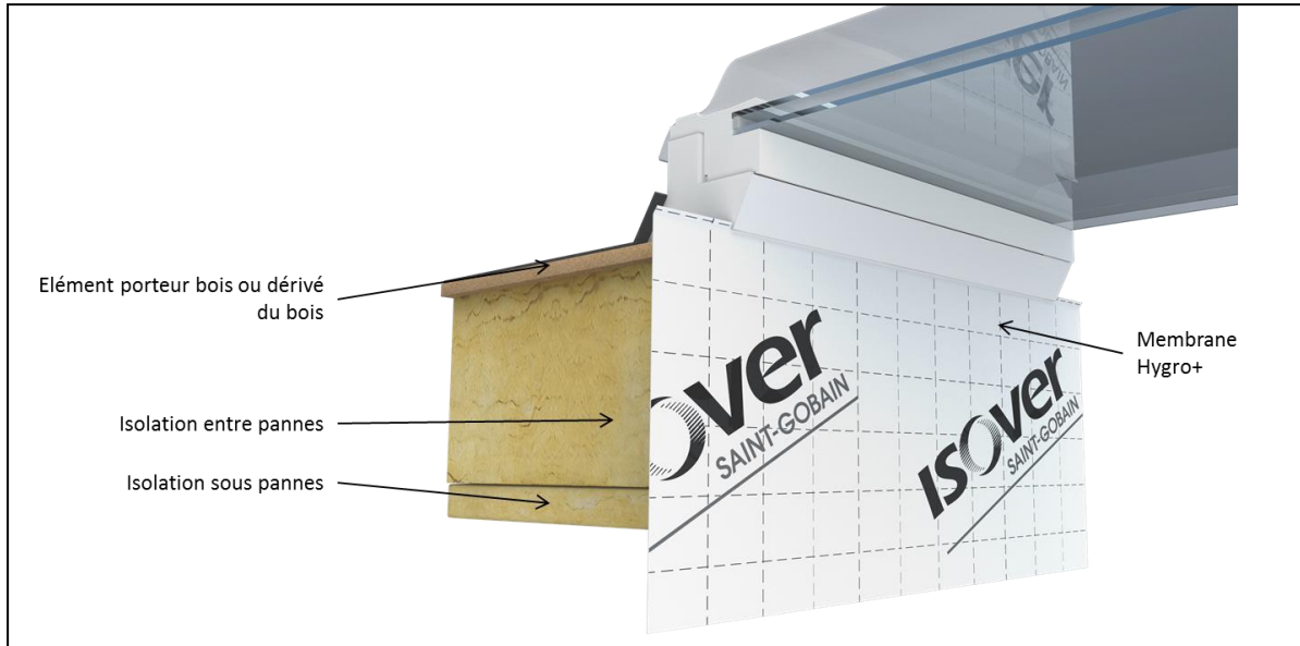
Figure 34 – Vue en perspective du traitement de la pose d’une fenêtre de toit dans le complexe isolé et pose de la bavette ou colerette
