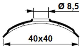
Description : Plaquette de répartition nervurée et emboutie selon le profil de l'onde. Pour toutes fixations de Ø 6 à 6,5 mm
