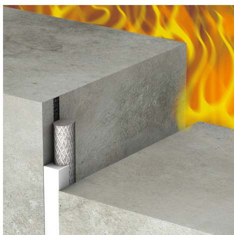
Exemple d'utilisation de la colle FOI42 avec le bourrelet FJ203 Altofeu et le silicone FS703.
