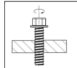
Valeurs de test à l'arrachement pur (Pk en daN) - Conforme à la norme NF P 30-310.
