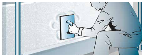
Fig. 5 : Les panneaux sont frappés et pressés à l'aide d'un bouclier
