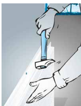
Fig. 9d : Fixation mécanique du profilé
