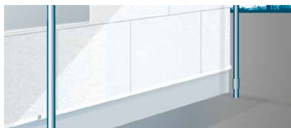
Fig. 4 : Pose des panneaux, façon "joint de pierre"
