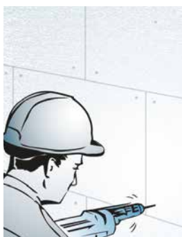
Fig. 8 : Fixation des chevilles
