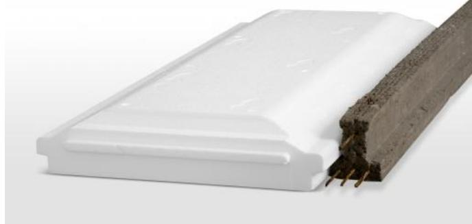
Coffrabox 12 PP est un entrevous en PSE issu de la technologie PSE moulé et utilisé pour le coffrage des planchers poutrelles de technologie Précontraint. Il réduit fortement la charge propre du plancher et, ainsi permet de mieux dimensionner les structures par rapport aux charges d'exploitation admissibles.
