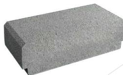
**Entrevous béton creux borgne** qui, posé à chaque extrémité transversale du plancher ou en bord de trémie, évite que le béton ne remplisse la partie creuse des entrevous courants lors du coulage.
