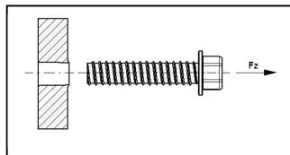
Valeurs de test de charge de cisaillement de l'assemblage (Pk en daN) - Conforme à la NF P 30-316.
