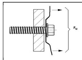
Valeurs de test à l'arrachement pur (Pk en daN) - Conforme à la norme NF P 30-310.
