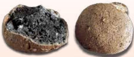
L'argile expansée **Laterlite Plus** est un agrégat léger et isolant obtenu avec seulement de l'argile naturelle, expansée et clinckérisée à 1200° C, caractérisée par une structure interne cellulaire enfermée dans une écorce dure et résistante.
