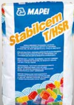
de pompes (pompes manuelles, pompes à enduits etc.) il convient de préparer le mortier à l'aide d'un malaxeur électrique et procéder de la façon suivante : dans un seau, verser 4 litres d'eau puis ajouter lentement, sous agitation, 25 kg de **Stabilcem T/HSR**. Malaxer pendant 2 à 3 minutes jusqu'à obtention d'un mortier homogène, sans grumeaux.
