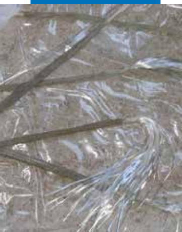
Polymérisation de MapeWrap FIOCCO pendant 24 heures
