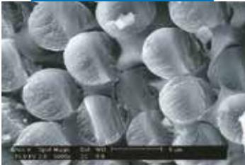
Vue au microscope électronique des fibres agglomérées dans la matrice Epoxy
